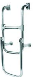
Aus rostfreiem Stahlrohr 25mm, AISI316. Klappbar, durch schwenkbare Befestigungsbügel ist diese Leiter sowohl am Rumpf als auch an Deck montierbar. Die Abstandhalter sind verstellbar.
