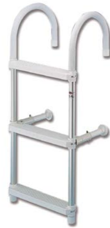
Leitern aus silberem Aluminium. Rohrdurchmesser 25 mm. Sprossen aus gleitsicherem Kunststoff, mit zwei verstellbaren Abstandhaltern. Die Holme und Abstandhalter der Leitern sind nach Innen schwenkbar.
