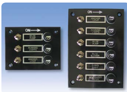
Platte aus schwarzem Kunststoff. Kippschalter aus verchromtem Messing. Jeder Schalter ist mit einer Glasrohr-Sicherung verbunden. Komplett verdrahtet. 6 Bezeichnungsschilder sind beige packt. In zwei Größen lieferbar. 3-fach 115 x 93 mm 56 6117 6-fach 115 x 165 mm 56 6116
